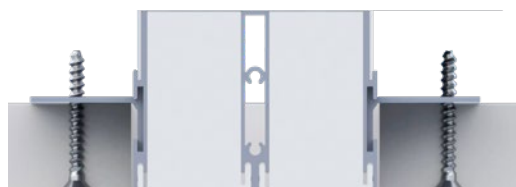
Particolare di fissaggio con PG...-DLP su lastra in cartongesso da 12,5 mm
